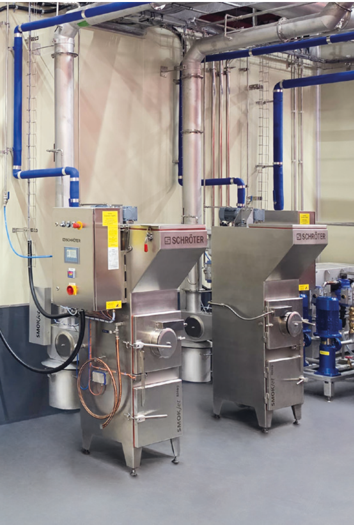
HACKSPÄNE-RAUCHERZEUGER SMOKjet® RH09 mit 1-fach Abgang versorgen die SEMIjet® mit Rauch.
