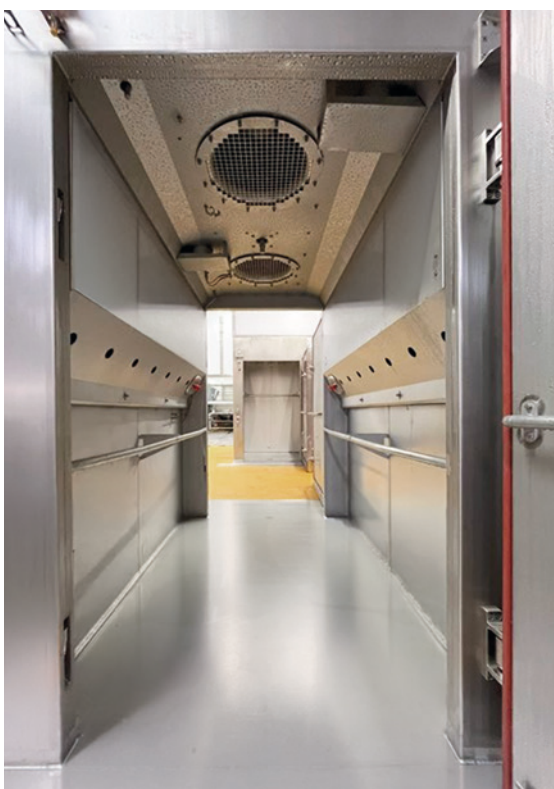
BLICK DURCH DIE INTENSIVKÜHLANLAGE ARCTICjet® IK-2 in Transitausführung mit zwei stufenlosen Umluftventilatoren
