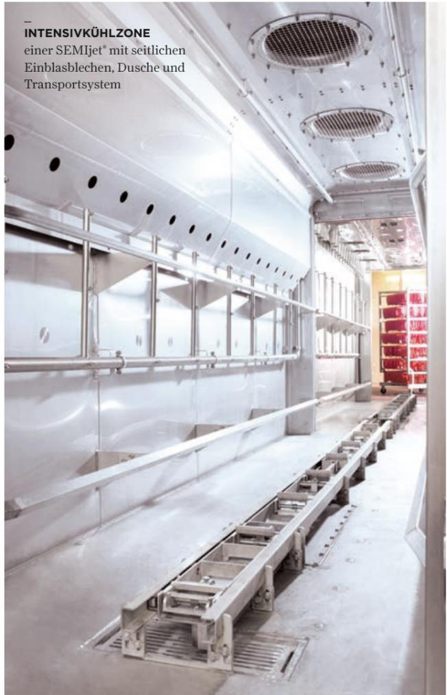
INTENSIVKÜHLZONE einer SEMIjet® mit seitlichen Einblasblechen, Dusche und Transportsystem
